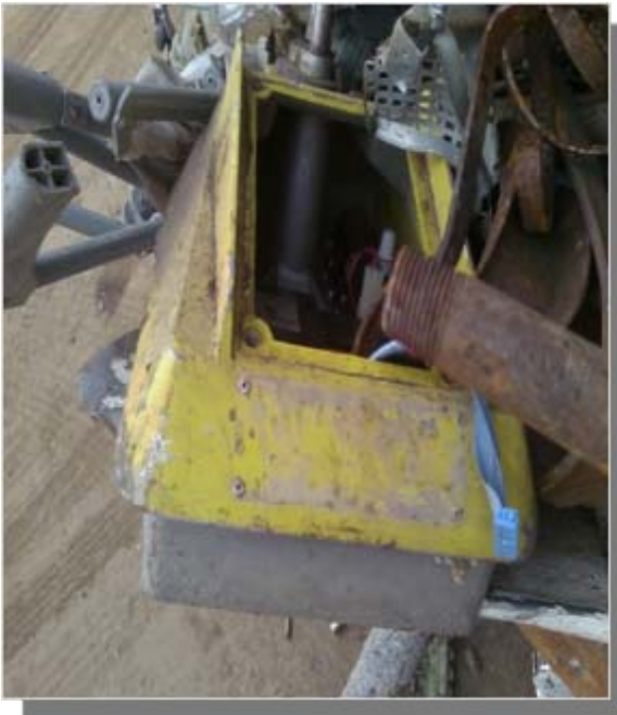
Jauge portative endommagée
